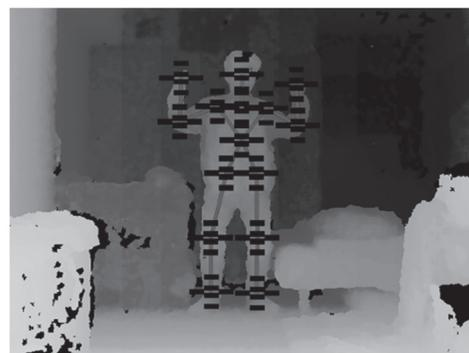
図 1 7 Synapse による人体のスケルトン運動情報の取得
