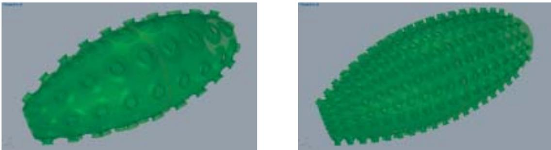
図9・10 変数値によるパラメトリック・モデルのサーフェイス形状の変化
