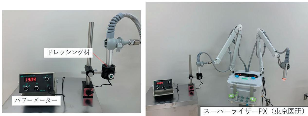
図 1 : 近赤外線透過率の計測
